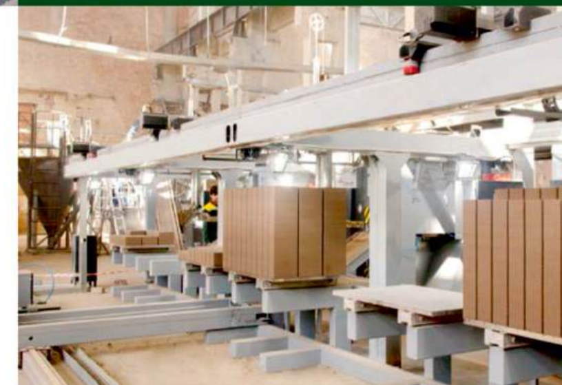
УЧАСТОК ПРЕССОВАНИЯ АВТОМАТИЗИРОВАННОЙ ЛИНИИ ПРОИЗВОДСТВА ГИПЕРПРЕССОВАННОГО КИРПИЧА
